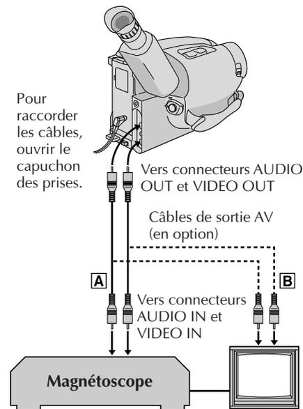
Il y a trois types de raccordement de base. En faisant les raccordements, se référer également aux manuels d'instructions de votre magnétoscope et de votre téléviseur.
