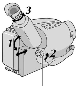
Placer l'interrupteur d'alimentation sur "CAMERA".
